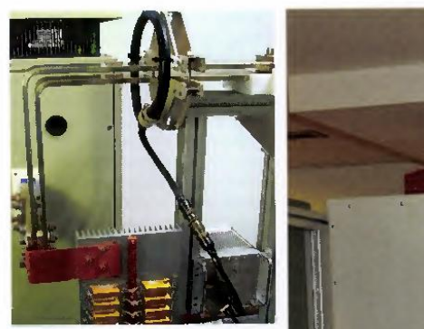
Clipsable, le capteur innovant développé par Neelogy mesure le courant alternatif comme le courant continu via la lecture du champ magnétique.
